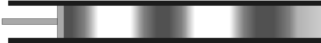
Fig. 2: Door sinusvormige beweging van een zuiger in een nauwe buis ontstaat een sinusvormige drukgolf.
